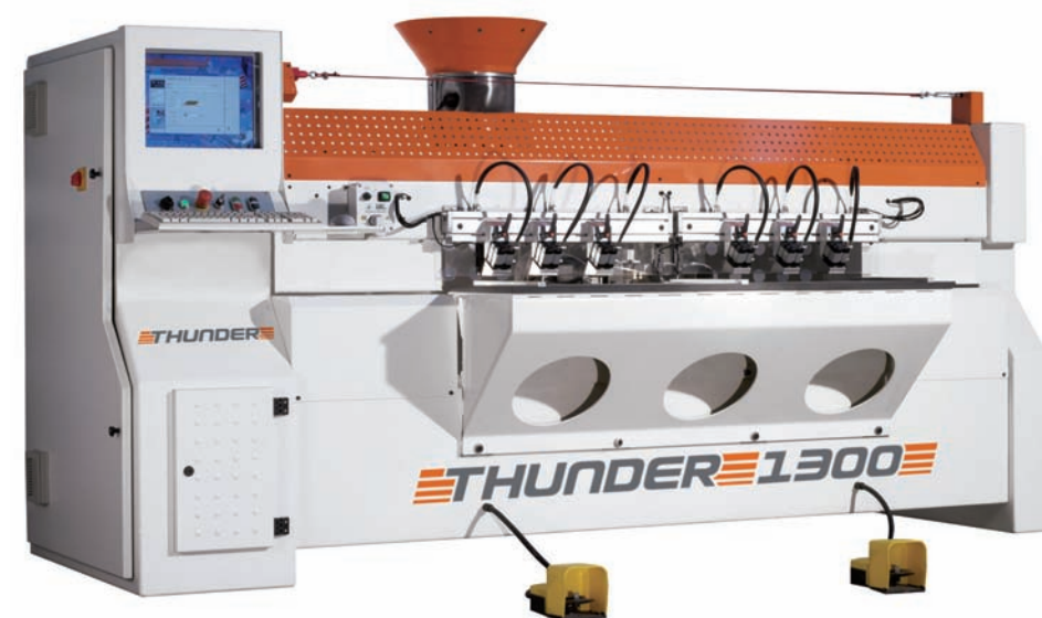
Thunder è una fora-inseritrice di spine a Cnc per porte e finestre di Vitap, macchina nella quale si è fatto largo uso di componenti Panasonic.
