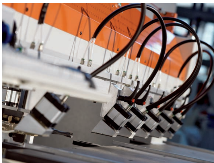
Dettaglio del piano di lavoro completo di pressori sulla fora-inseritrice Thunder di Vitap.
