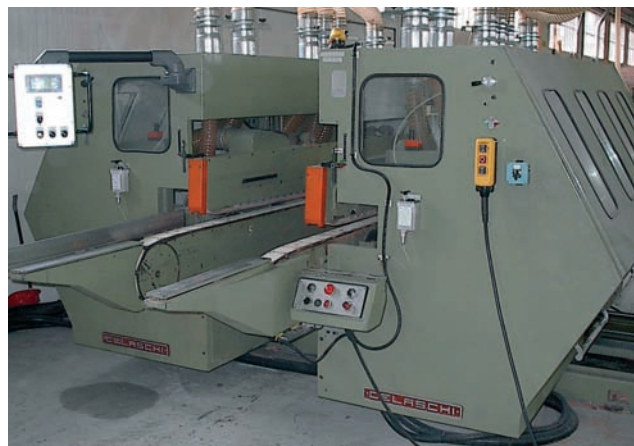
Vista anteriore della squadratrice con pulpito comando dotato di monitor touch screen, collegato alla cassetta controllo motore posizionario spalla mobile.
