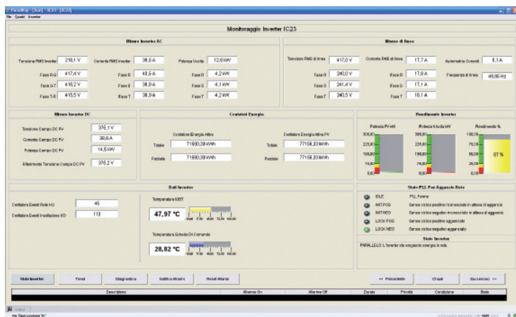
Sinottico parametrizzabile che mostra lo stato dell'inverter e indica se presenti eventuali anomalie.
