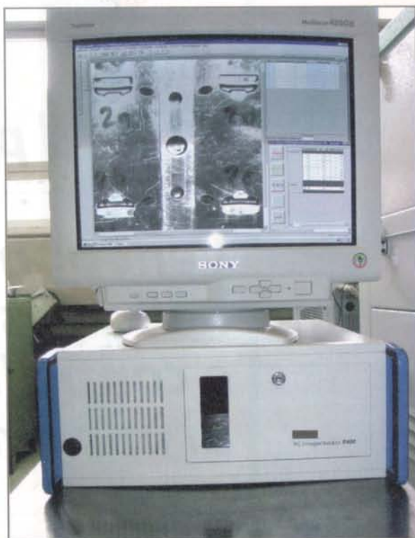
Grazie all'acquisizione e all'analisi dell'immagine in tempo reale e al controllo online il sistema assicura un'elevata qualità dello stampaggio
